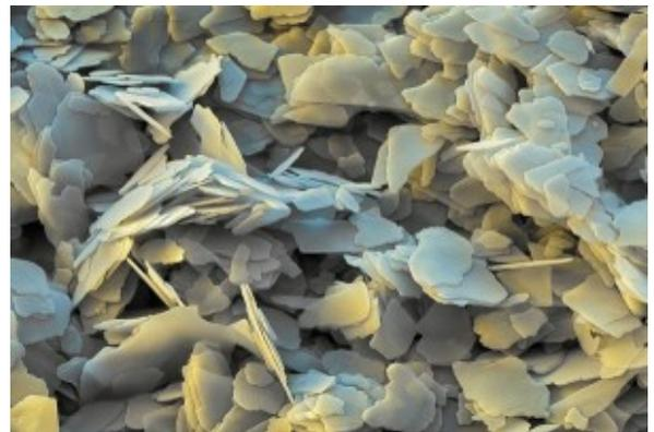
1. Biossido di titanio visto al microscopio elettronico
